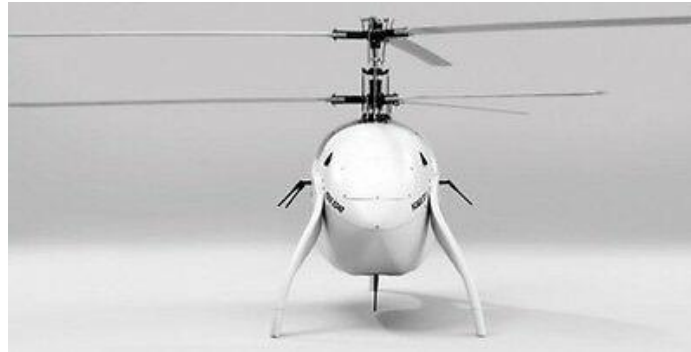
Figura 8. Aeronave con dos rotores coaxial.
